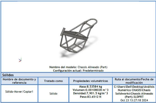
Fig. 5. Información del chasis (Acero AISI 1018).
