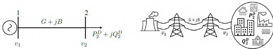
Fig. 1. Sistema de potencia de dos nodos (diagrama unifilar y representación real equivalente).
