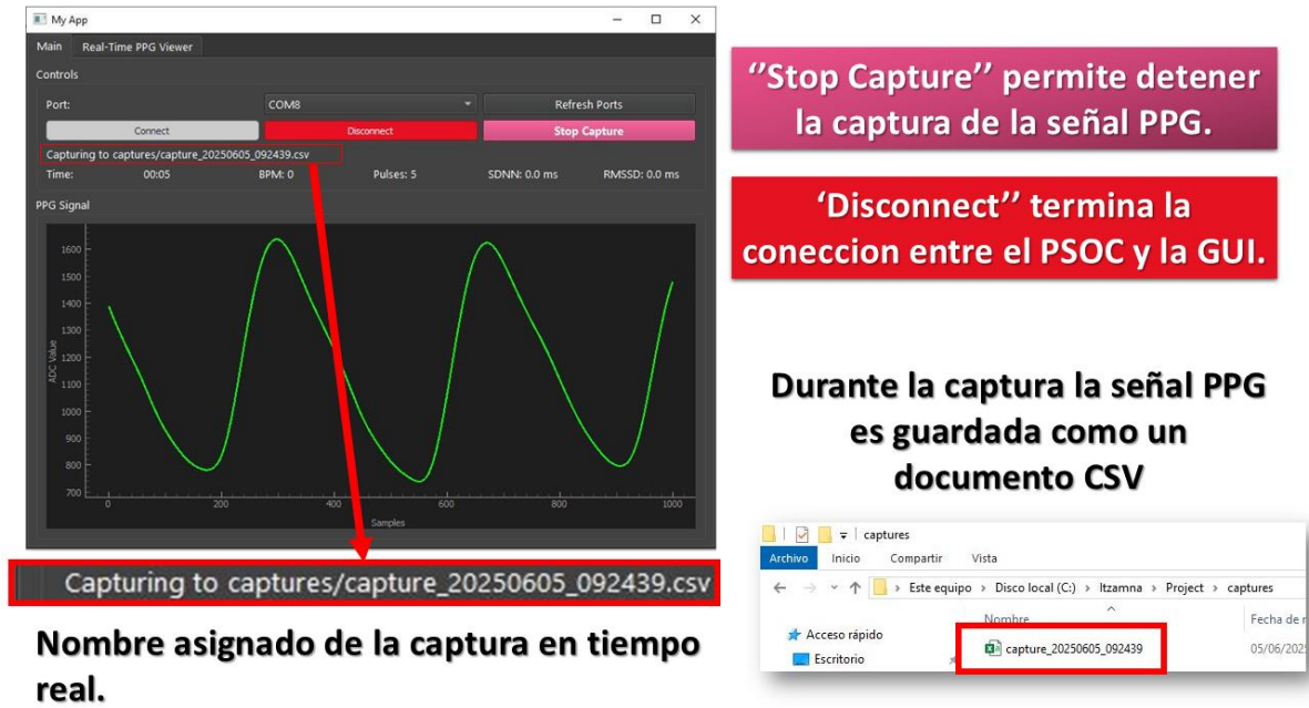
Fig. 3. Captura y almacenamiento de señal PPG en tiempo real mediante GUI conectada a PSoC. La señal se muestra en pantalla junto con parámetros fisiológicos como BPM, pulsos y métricas de HRV. La captura puede detenerse con el botón "Stop Capture", y la conexión finalizar con "Disconnect".
