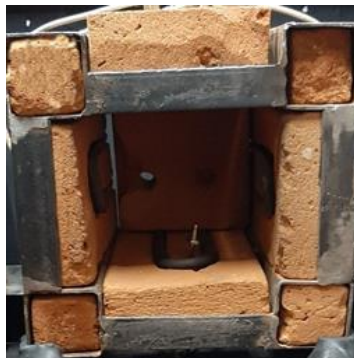
Fig. 10. Construcción final de la cámara térmica.
