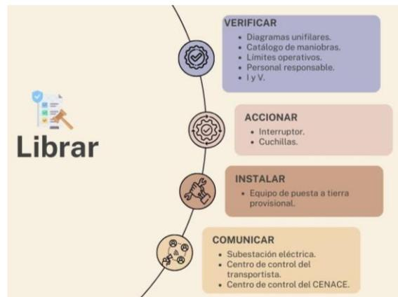
Fig. 2. Puntos para librar un elemento eléctrico.
