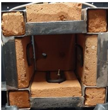
Fig. 10. Construcción final de la cámara térmica.
