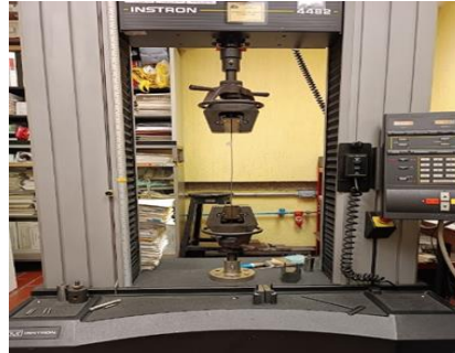
Fig. 9. Ensayo de tensión en máquina universal INSTRON 4482.
