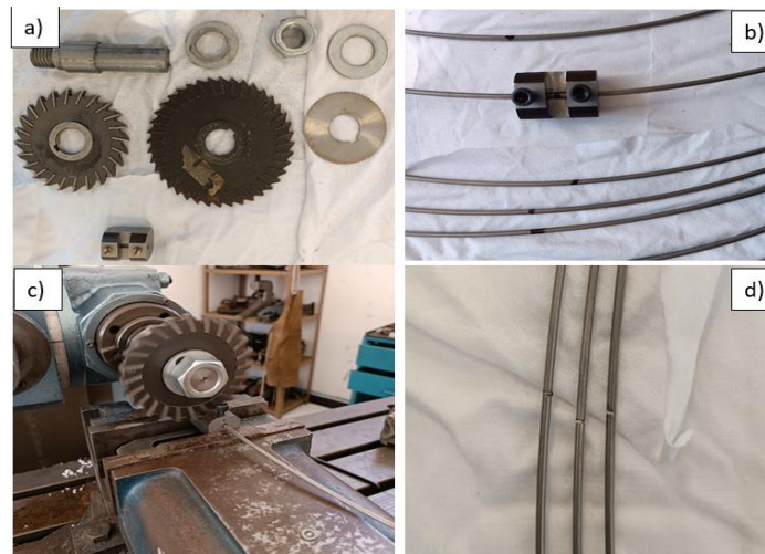
Fig. 6. Preparación de las muestras de ULA. a) Discos de corte y herramientas para realizar pruebas, b) Preparación de muestras, c) Realización de muesca a las muestras, d) Muestras realizadas.
