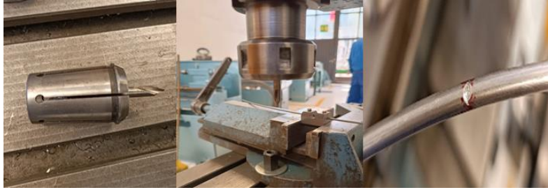
Fig. 7. Realización de defecto circulares.
