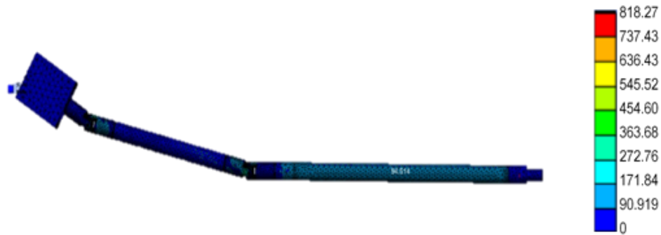
Fig. 9. Esfuerzos presentes en el cardán [MPa].
