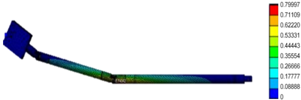
Fig. 8. Desplazamientos presentes en el cardán [mm].
