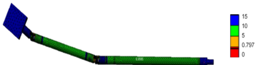
Fig. 8. Factor de seguridad estático presente en el cardán.
