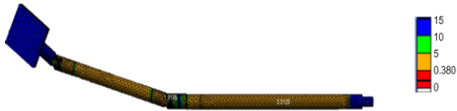
Fig. 11. Factor de seguridad dinámico presente en el cardán.
