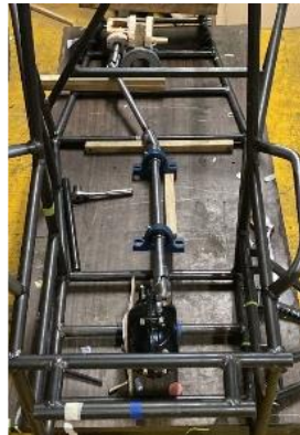
Fig. 12. Implementación del sistema de potencia
