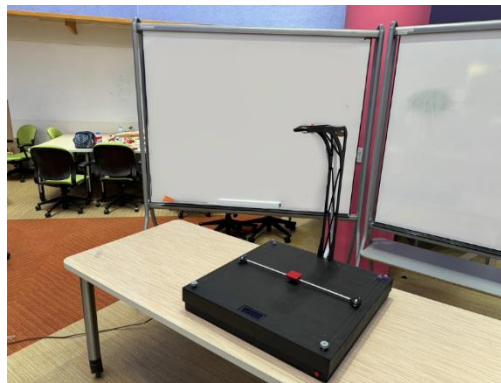
Fig. 4. Prototipo de entrenador biomecánico para reflejos deportivos.
