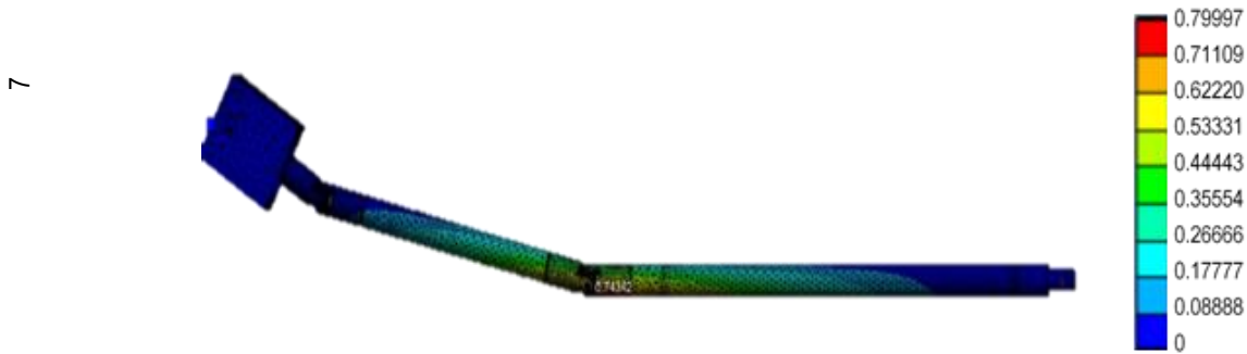
Fig. 8. Desplazamientos presentes en el cardán [mm].
