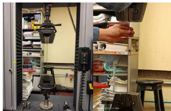
Fig. 10. Preparación de la máquina para pruebas de tensión.
