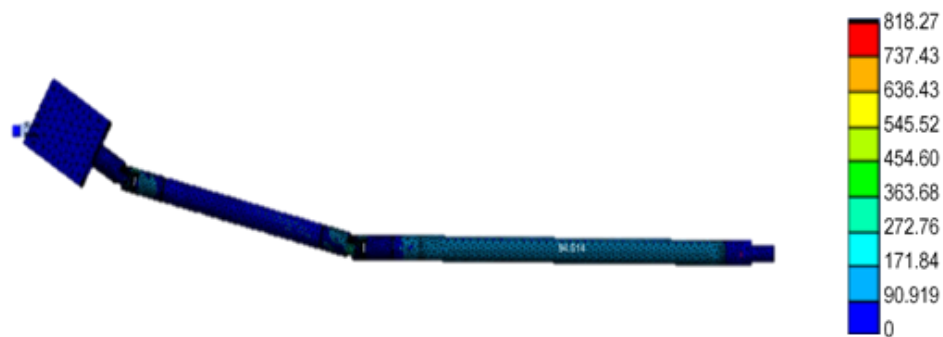
Fig. 9. Esfuerzos presentes en el cardán [MPa].
