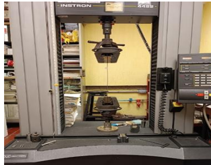
Fig. 9. Ensayo de tensión en máquina universal INSTRON 4482.
