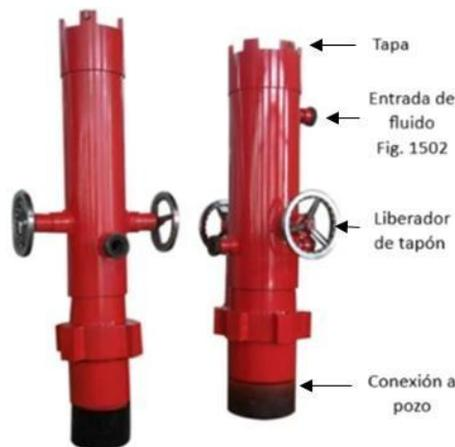
Fig. 1. Cabeza de cementación de un tapón [7].
