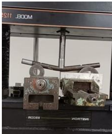
Fig. 15. Probeta después del ensayo de flexión en 3 puntos.
