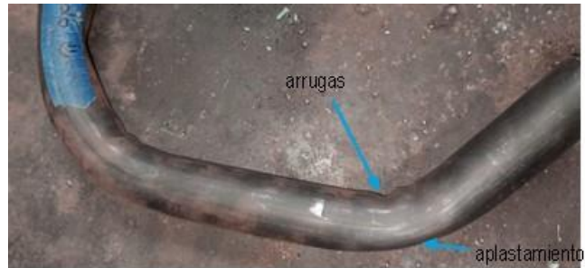
Fig. 8. Defectos por el doblado manual
