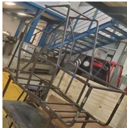
Fig. 7. Diseño realizado para la jaula del vehículo BAJA SAE 2023.
