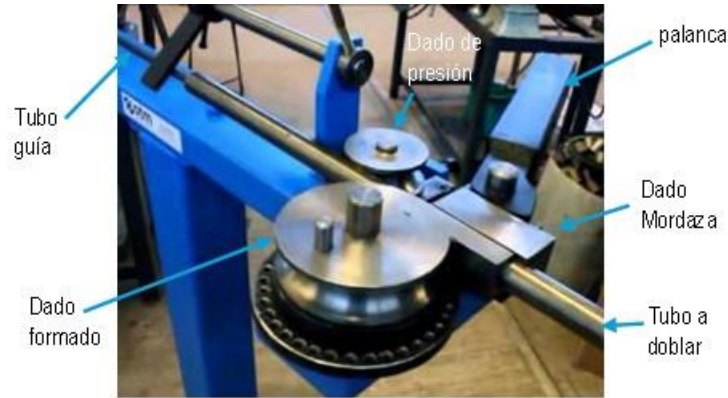
Fig. 3. Dobladora de tubos manual equipada para el doblado de tubo.
