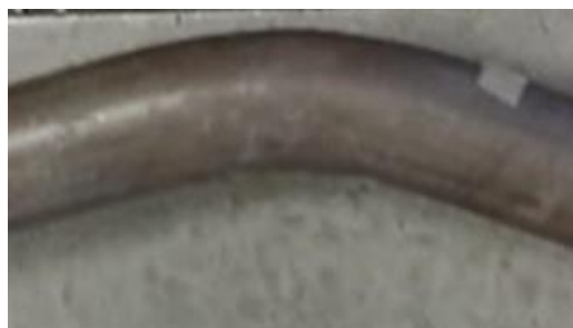
Fig. 16. Probeta doblada sin defectos.
