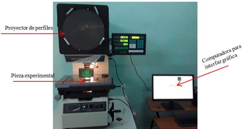
Fig. 5. Disposición para la digitalización de la geometría del punzón de corte.
