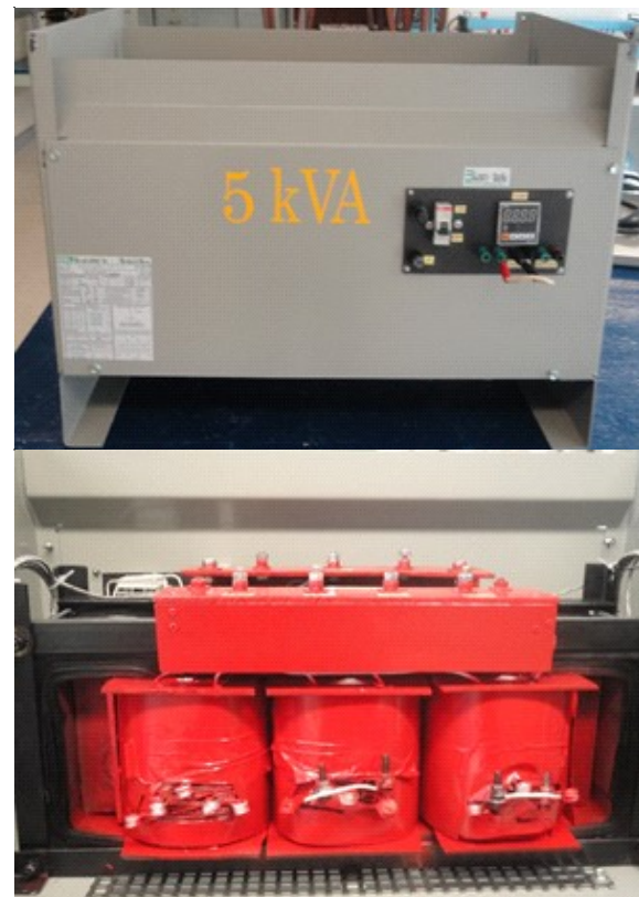
Fig. 1. Gabinete y bobinas del transformador de 5 kVA.
