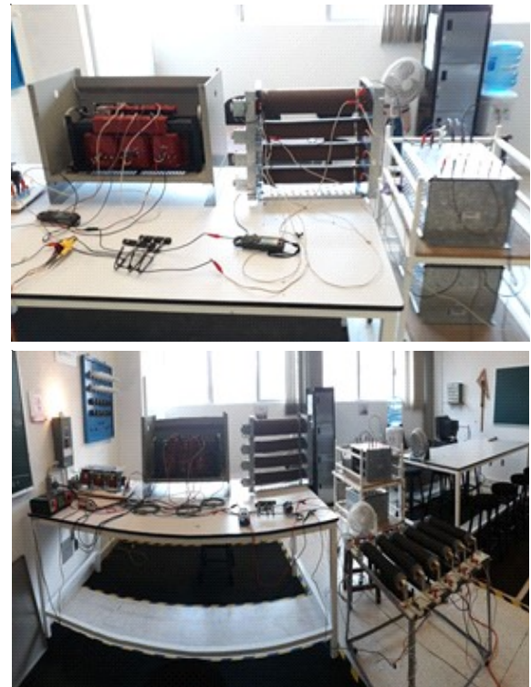
Fig. 5. Mediciones en el transformador con el rectificador trifásico y carga resistiva.
