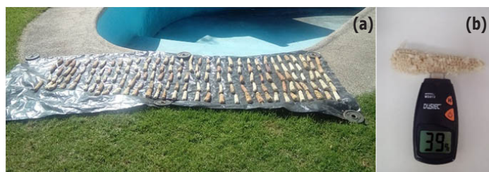
Fig. 1. Secado de las tusas de maíz al aire libre (a) y humedad inicial de las tusas (b).
