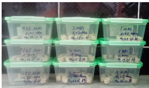
Fig. 3. Muestras compactadas de olote de maíz.
