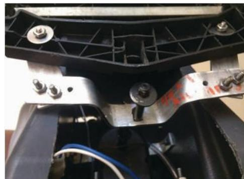
Fig. 4. Componentes para el control de dirección del vehículo: marco de aluminio y columna de dirección con motor cc acoplado.
