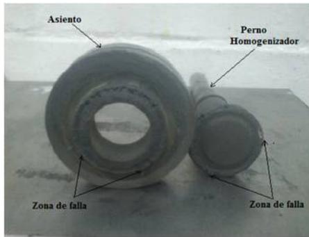
**Fig. 3.** Sistema de homogenización después de operación con falla en la perifería.
