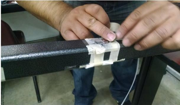
**Fig. 9.** Soldado de los alambres conductores a una de las galgas.
