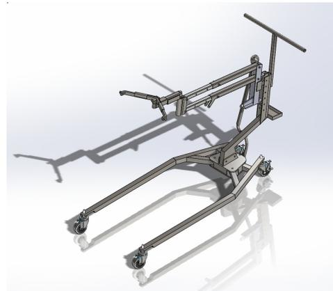
**Fig. 17.** Ensamble final de la grúa en SolidWorks® 2014.
