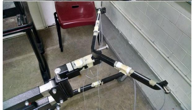
**Fig. 11.** Imágenes de la grúa completamente instrumentada con galgas extensométricas listas para ser utilizadas en las pruebas.
