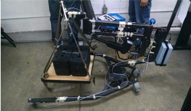
Fig. 13. Imagen de la grúa cargando 36 kg.
